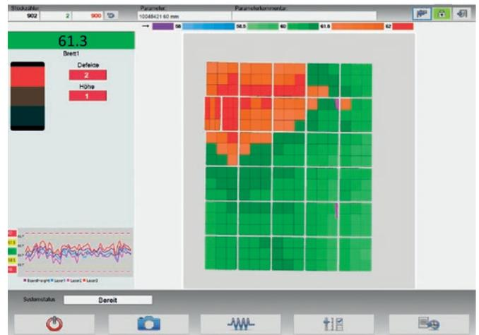
Der Bediener erhält eine reelle Ansicht der produzierten Steine in farblicher Darstellung, um den Höhenverlauf der Steine auf der Produktionsplatte einfach zu erkennen. Gleichzeitig werden Fehler auf der Oberfläche angezeigt.
